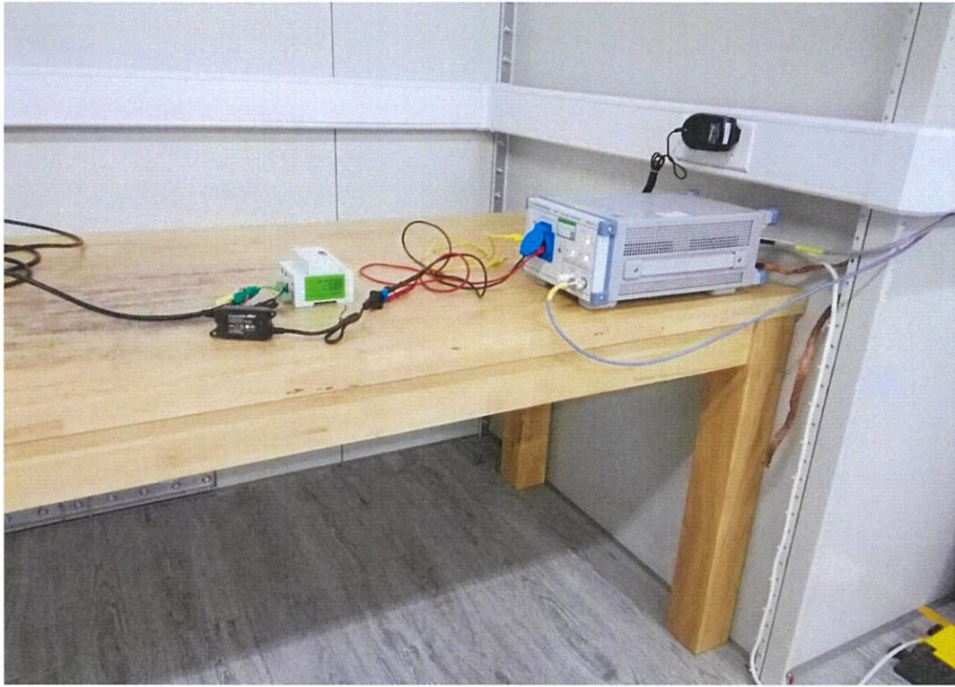
图 5: 传导发射限值检验配置图
