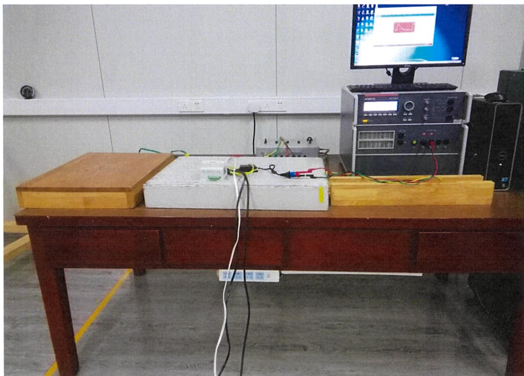
图 4: 浪涌抗扰度检验配置图
